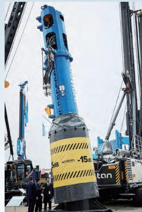
プラスチック製のカバーでスリーブ部分を覆い、騒音を軽減させます。
